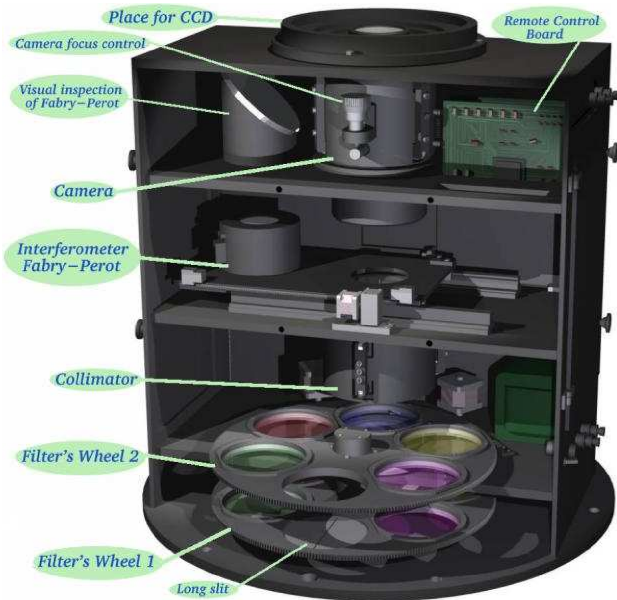
Рис. 1.2: Устройство редуктора светосилы SCORPIO
