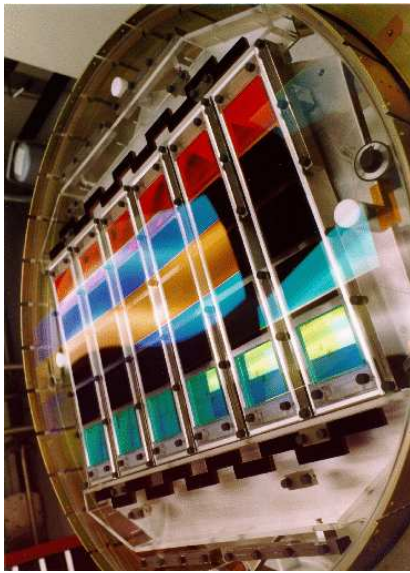
Рис. 2: Слева: Массив CCD матриц 2.5 метрового телескопа обзора Sloan Digital Sky Survey (SDSS) с фильтрами r, i, u, z, g . Справа: принцип переноса заряда в CCD. Пакеты зарядов (электроны, показаны голубым цветом) собираются в потенциальных ямах (показаны жёлтым), созданных приложенным напряжением на затворных электродах (G). Подача напряжения на затворные электроды в правильной последовательности перемещает пакеты зарядов.
